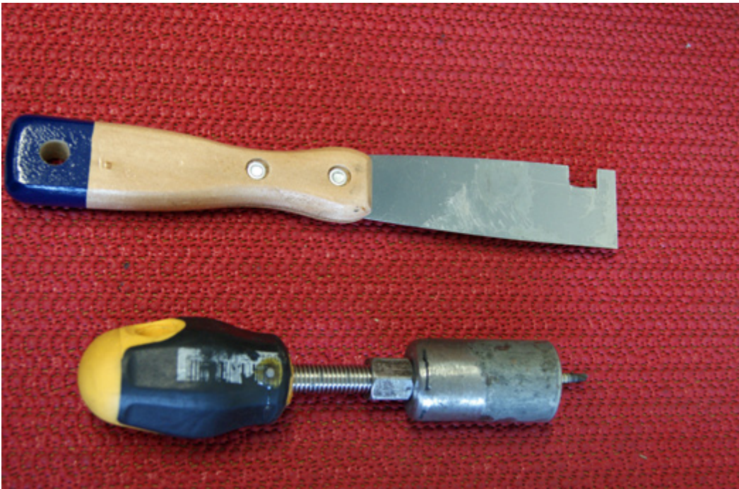
Tatwerkzeug: Spachtel für „Türvierkant“ und Ziehfix.
