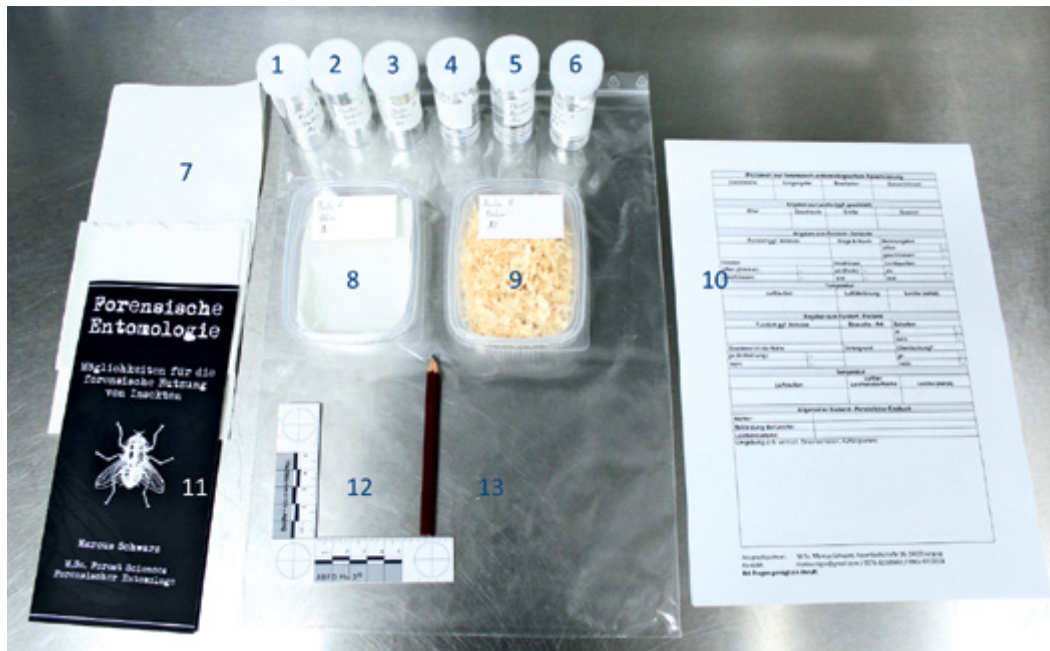
Abbildung 2: Set zur schnellen Asservierung von forensisch-entomologischen Spuren (Nr. 1-3 Probefläschchen leer für Asservierung von Puppenhüllen oder Puppen (Löcher im Deckel); 4-6 Probefläschchen mit 70% Ethanol für Tot-Asservierung vor Ort; 7 Krepptpapier zur rüttelfreien Lagerung in Nr. 1-3 oder Nr. 8; Nr. 8 Dose mit Deckel (Löcher nicht vergessen) zur Lebendasservierung von Larven mit Nahrung; Nr. 9 Dose mit Einstreu, mit Deckel (Löcher nicht vergessen) zur Lebendasservierung von Larven (nur 3. Larvenstadium) oder Puppen; Nr. 10 Fragebogen; Nr. 11 Flyer mit Asservierungsanleitung; Nr. 12 Maßstab; Nr. 13 Bleistift.
