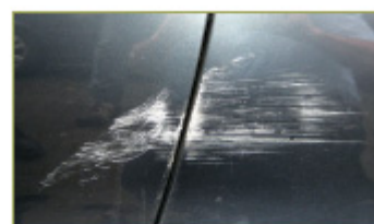
Bild 2: Schadensbereich an der Fahrertür
