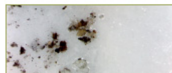
Bild 4: fühlbare und sichtbare mineralische Partikel von der Folie, 220fache Vergrößerung, Partikel eines mineralischen Putzes
