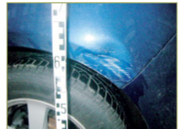
Lichtbild 6: Schadenbereich am Radlauf
