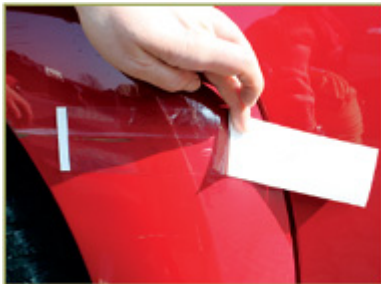
Lichtbild 1: Spurensicherung mittels Spurfix Folie
