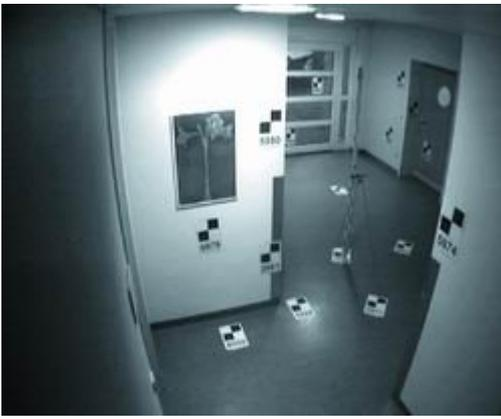
Bild 6: Vergleichsbild mit Referenzpunkten und Messlatte
