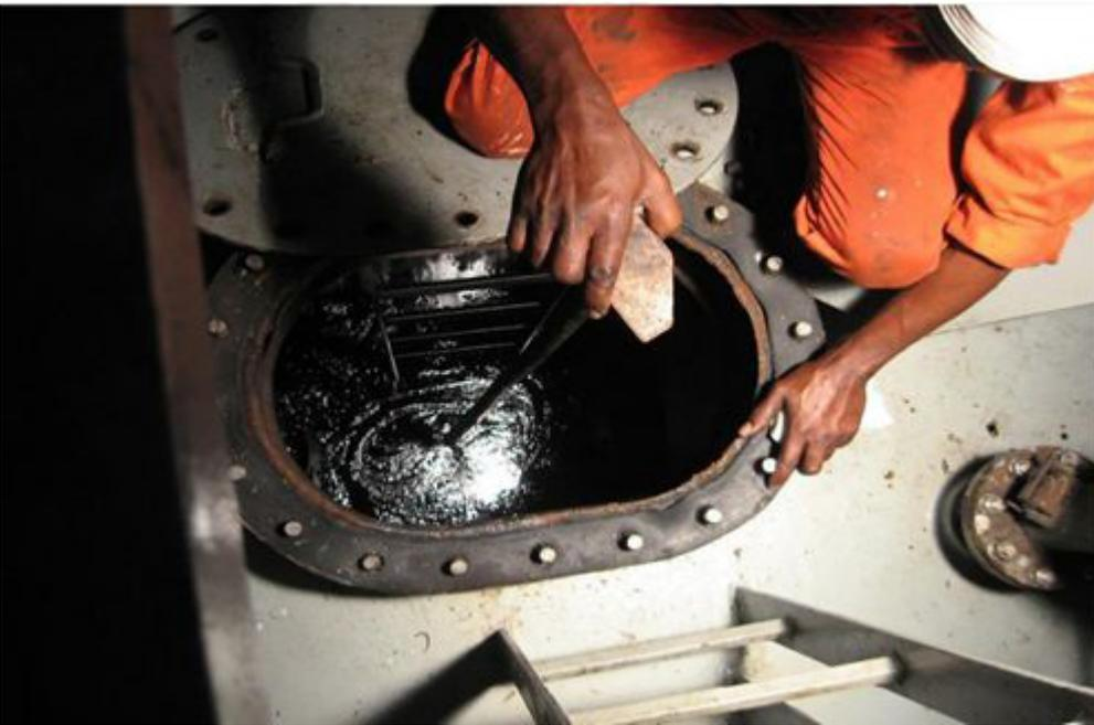
Abb. 1: Stark mit öligen Rückständen kontaminierter Mannlochdeckel eines Bilgenwassertanks.
