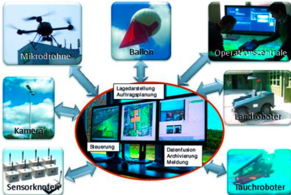
Abbildung 4: Beispielkonfiguration AMFIS
