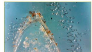
Bild 14: Folienabzug einer Zacke, an der Spitze haben sich braune Spuren angetragen, die vom Gummi des Reifen stammen können
