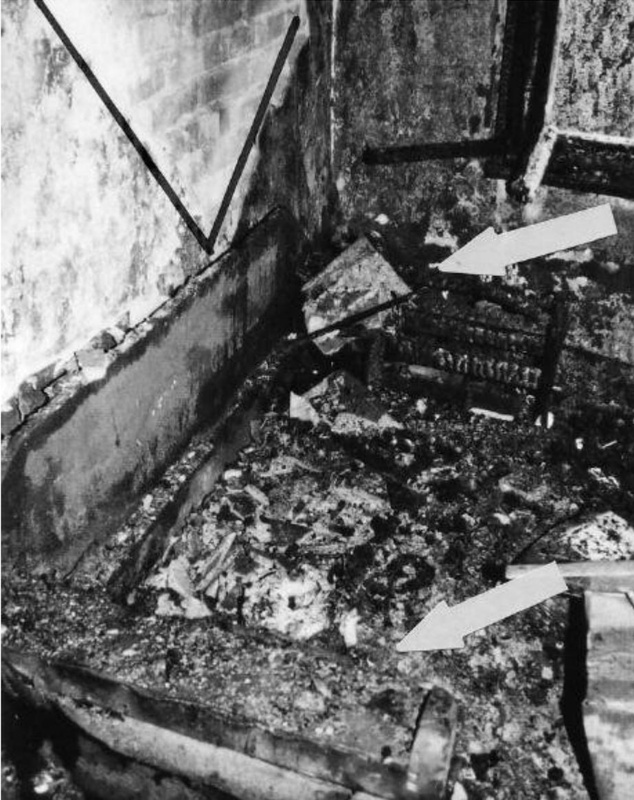
Die Auflagen des ausgeklappten Mittel- und Fußteiles sind vollständig verbrannt, so dass die Stahlfederung erkennbar ist. Der Kleiderschrank ist im oberen Teil durch den Brand stark zerstört und erheblich mit Ruß belastet. Aufgrund der Spurenlage konnte davon ausgegangen werden, dass es zu keinem Flashover und zum Vollbrand kam.
